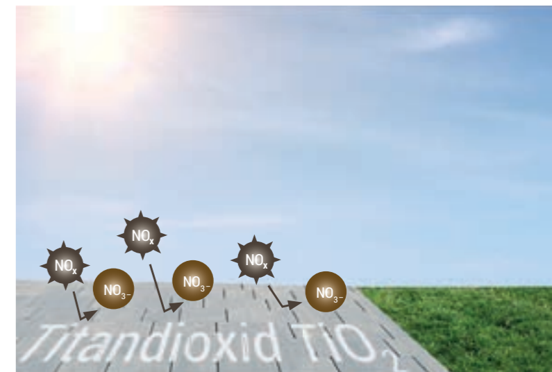
Mithilfe von Sonnenlicht wandelt Titandioxid ( \text{TiO}_2 ) Stickoxide ( \text{NO}_x ) in Nitrat ( \text{NO}_3^- ) um.
